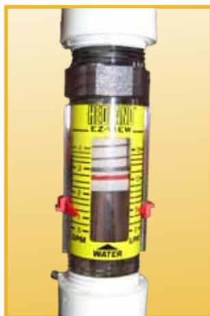
**Figura 8.** Rotámetro instalado en una tubería.
