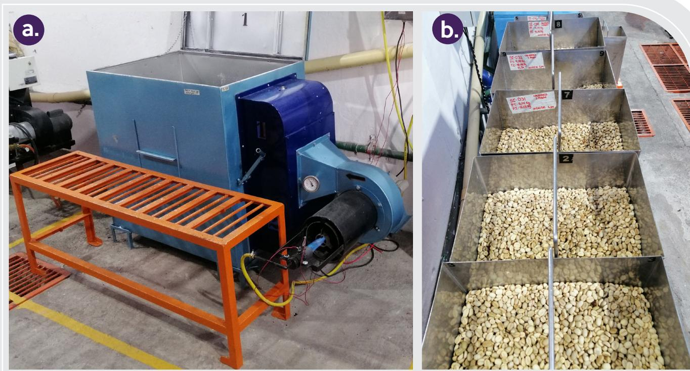
**Figura 2. Silo mecánico de capa estática (a) y café sometido a interrupciones (b).**
