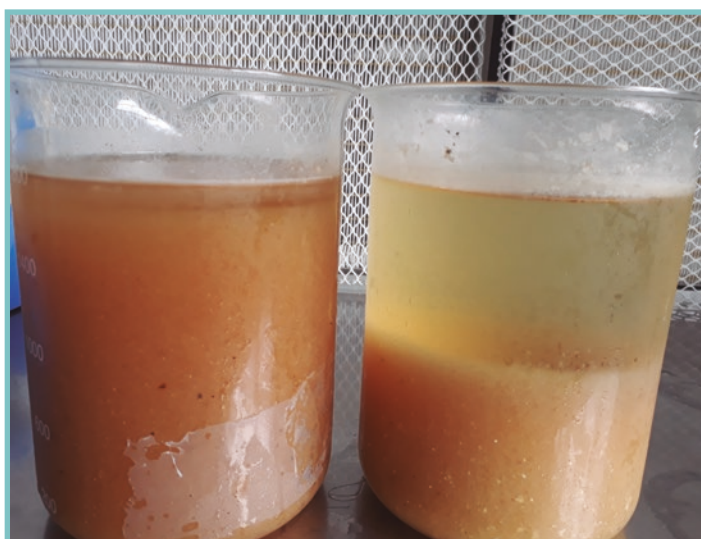
Figura 1. Aspecto del agua residual antes y después de agregar la cal.
