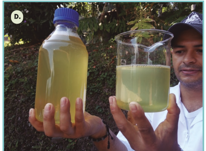
Figura 4. Procedimiento para el tratamiento primario del agua residual del café con cal apagada. A. Ingreso del agua al tanque, B. Adición de la cal, C. Agitación y precipitación, D. Aspecto final del agua residual después de la separación de lodos.
