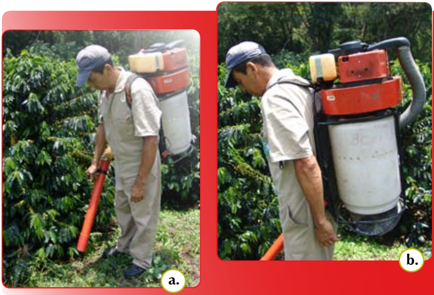
Figura 2. Equipo para recoger frutos del suelo Cifarelli V77S. a. Detalles del motor, ventilador, depósito para el material recogido y de la lanza empleada; b. Palanca para descargar el material recogido.
