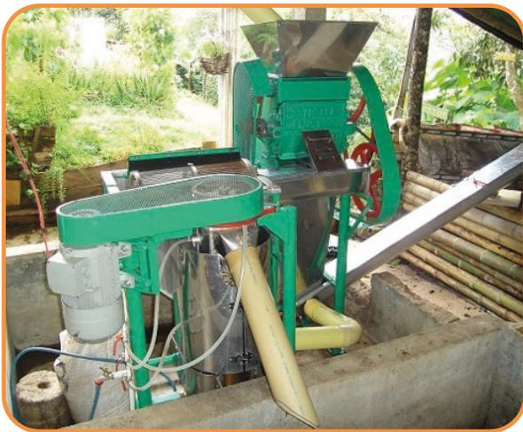
**Figura 2.** Adición a la pulpa de aguas de lavado del café. Con tornillo sinfín, con tecnología Becolsub.
