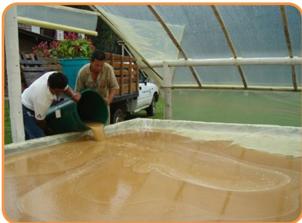
**Figura 3.** Secado solar de aguas residuales de lavado del café, generadas con la tecnología Ecomill®.
