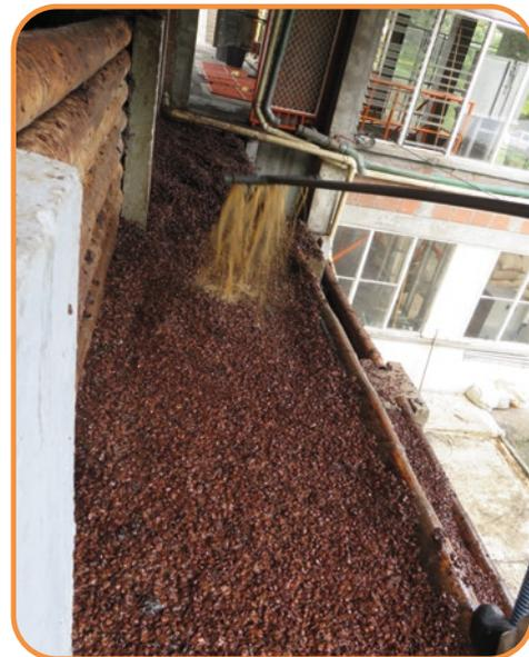
**Figura 4.** Adición de aguas de lavado del café a la pulpa, mediante riego, con tecnología Ecomill®.
