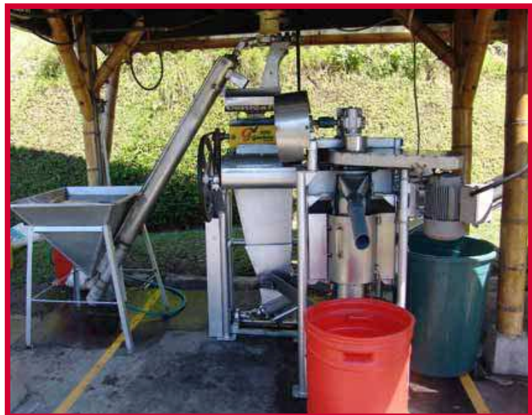
Figura 8. Módulo BECOLSUB 300 con un SHTS.
