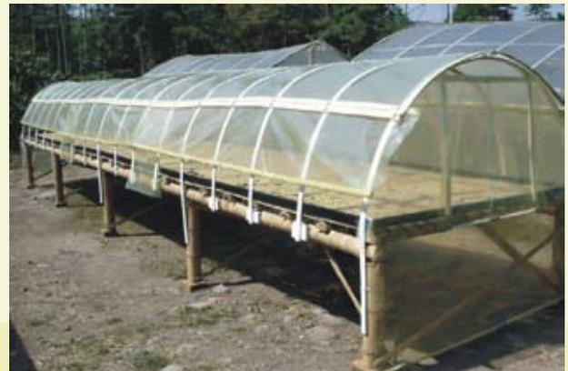
**Figura 9.** Operación del secador solar de túnel: **a)** Inicio de secado; **b)** Etapas avanzadas de secado.
