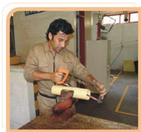
Figura 2. Corte longitudinal del tubo de PVC.
