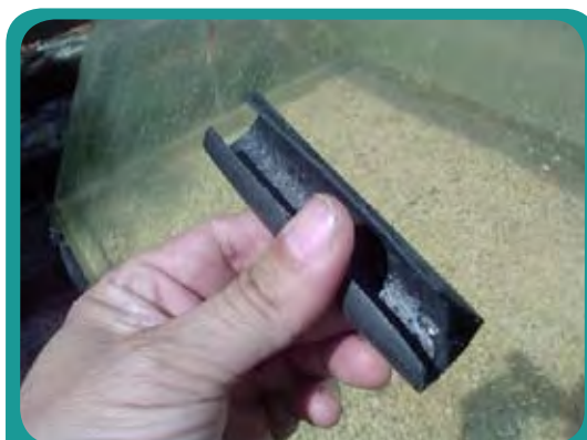
Figura 9. Cánulas de 3/4 pulgadas para sujetar el plástico a presión sobre manguera de 1/2 pulgada.
