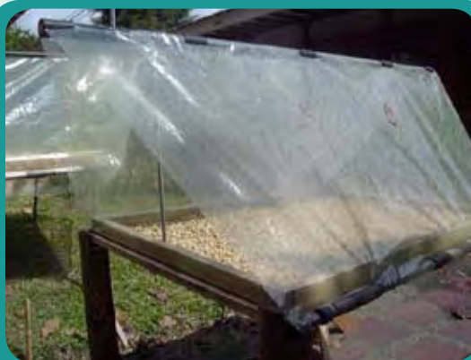
Figura 15. Pasera solar para 90 kg de cereza. Tratamiento (T1).
