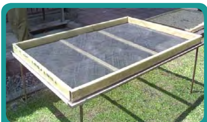
Figura 1. Bandeja estándar de 1,5 m largo x 1,0 m de ancho x 8cm de altura. Capacidad 90 kg de cereza.
