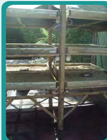
Figura 16. Pasera solar para 540 kg de cereza. Tratamiento (T2).
