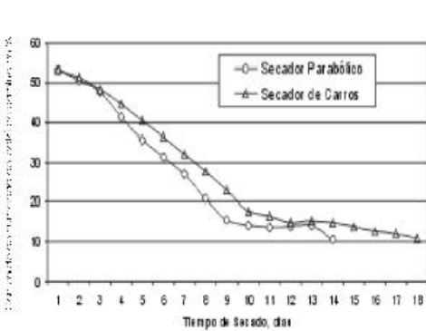
Figura 5. Comparación del secado de capas de café dispuestas en los carros convencionales y en el secador solar con cubierta parabólica
