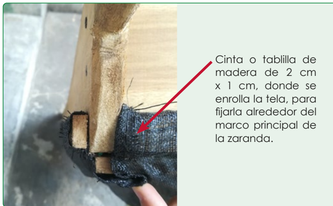
Figura 11. Detalle de tela enrollada y fijada con la tablilla de madera al marco principal.
