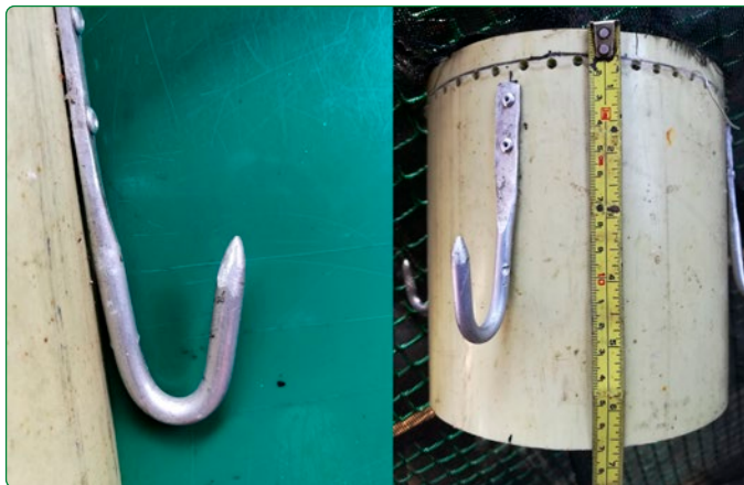
Figura 13. Detalle de ganchos para sujetar la estopa o costal.
