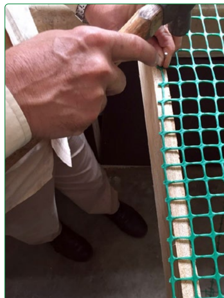
Figura 7. Fijación de la malla al marco principal.
