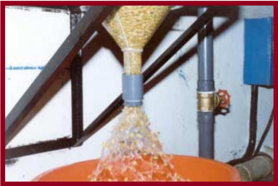
Figura 1. Evacuación de granos buenos por el ápice del hidrociclón.
