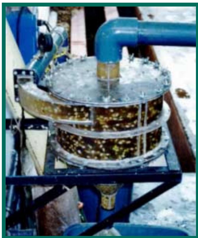
Vista general de un hidrociclón.
