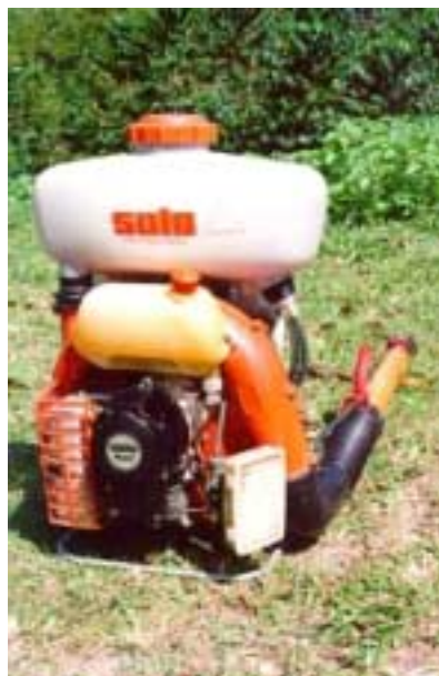
Figura 2. Equipo de aspersión motorizado de espalda con ventilador Solo Port 423
