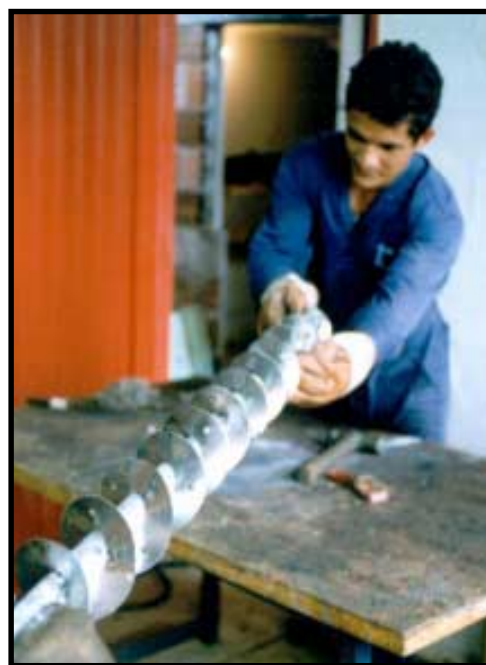
Figura 9. Discos estirados completamente sobre el eje
