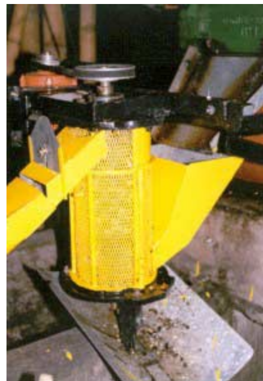
Figura 1. Desmucilaginoso mecánico diseñado por Cenicafe para capacidad menor de 750 Kg de café cereza/hora
