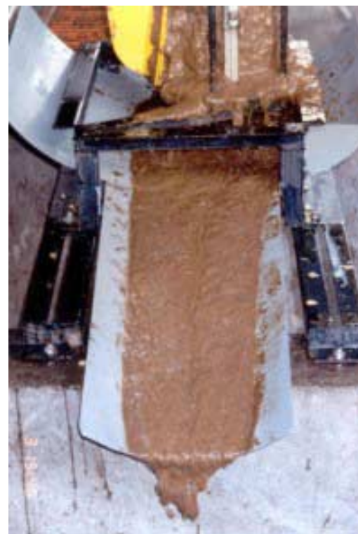
Figura 7. Mucilaginado extraído en el proceso mecánico. Es viscoso y tiene un alto contenido de sólidos suspendidos.
