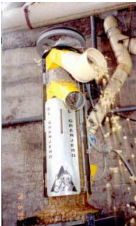
Figura 2. Desmucilagador para capacidad mayor a 3.000 Kg café cereza/hora. Obsérvese el mucílago que se extrae de la masa de café en baba.
