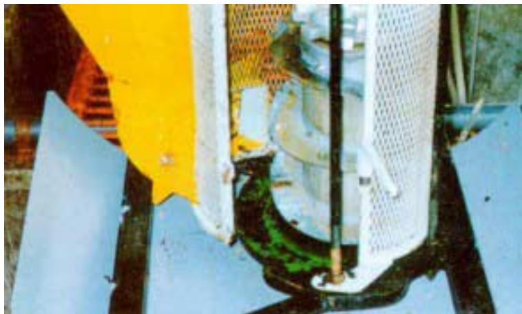
Figura 6. Tornillo sinfin de EL Granjero. Nótese su mayor longitud.
