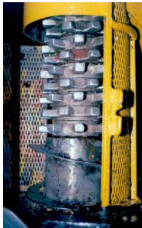
Figura 4. Agitador tipo COLMECANO y tornillo sinfin del desmucilagador El Granjerito.
