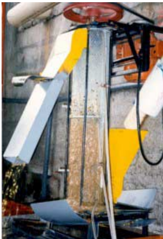
Figura 5. Desmucilagador El Granjero. La sección superior es la de lavado y la inferior de desmucilaginado
