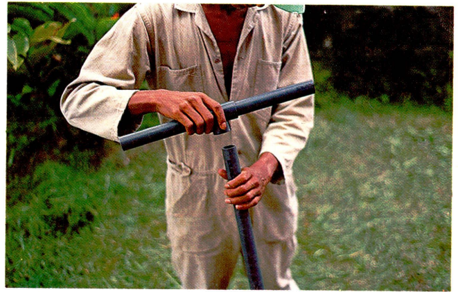
Figura 3. El equipo se arma utilizando los diferentes componentes, que se pegan con soldadura para PVC.
