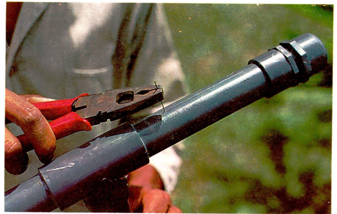
Figura 5. Se realizan 4 perforaciones con un alfiler caliente, a cada lado del tubo aplicador.
