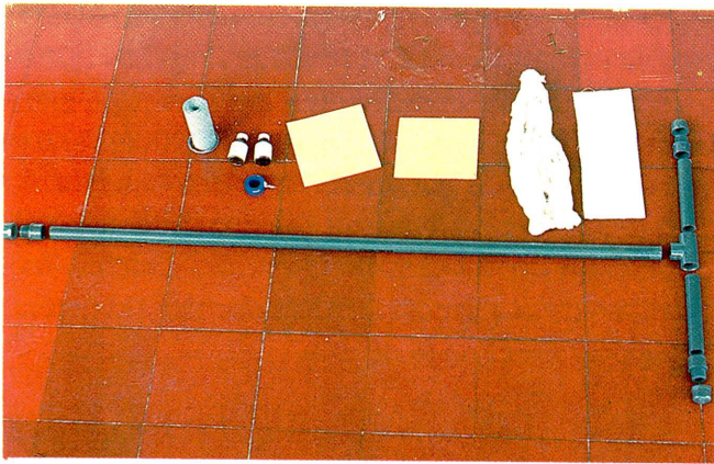
Figura 2. Componentes del selector de coberturas.
