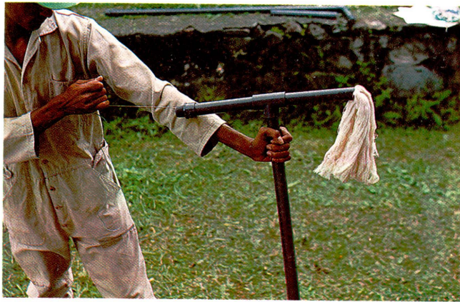
Figura 4. Introducción de la hilaza en el "aplicador".
