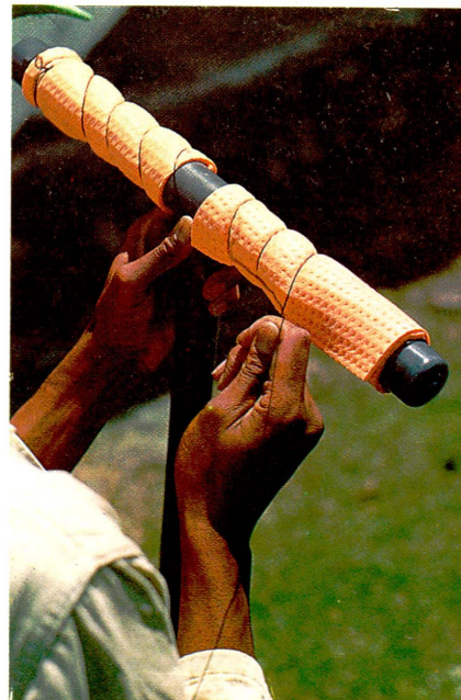
Figura 7. Se envuelve el tubo aplicador perforado con "limpiaseca" a cada lado.
