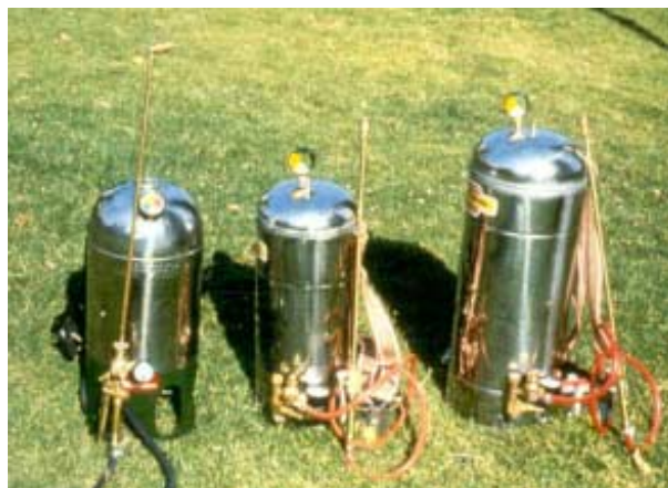
Figura 1. Aspersoras de presión previa retenida.
