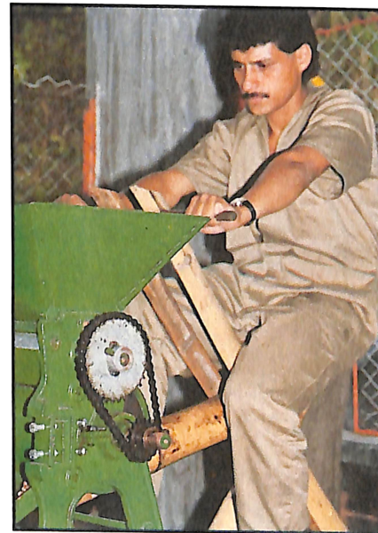
Figura 7. Despulpado con la máquina accionada a pedal, modificada en su relación de velocidad con corona dentada y cadena de rodillos.
