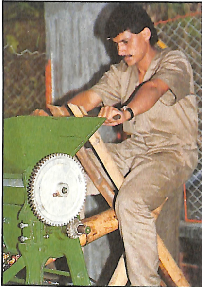
Figura 6. Despulpado mediante la máquina con piñones, accionada a pedal.
