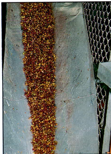
Figura 5. Utilización de la gravedad para transportar la pulpa a las fosas.
