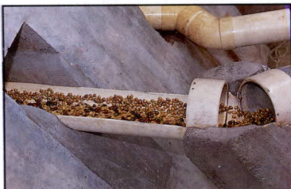
Figura 4. Utilización de la gravedad para transportar el café en baba.
