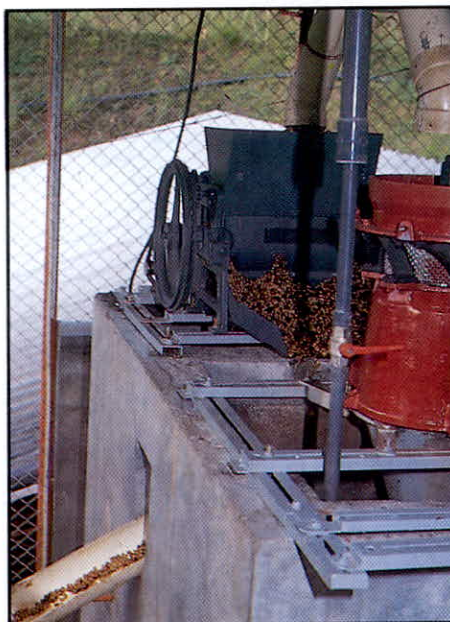
Figura 3. Aspecto general del sistema: cárcavo, despulpadora horizontal, canal abierto para transportar café en baba.
