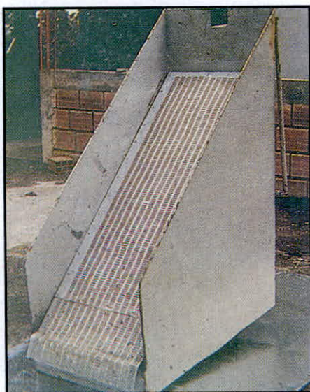
Figura 4. Separador pulpa-agua construido en lámina.
