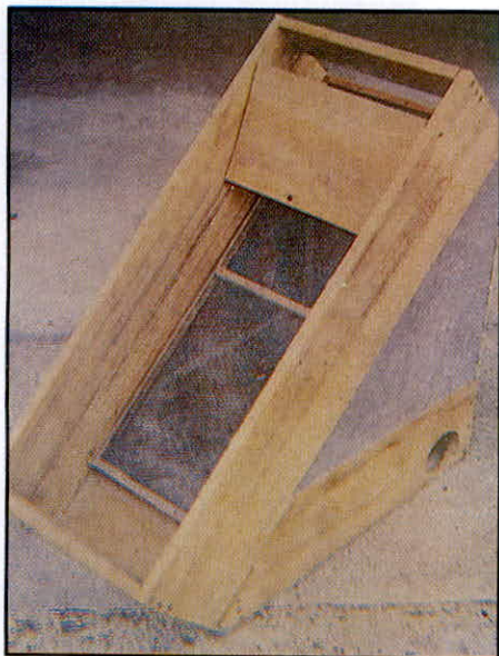
Separador construido en madera y anejo.
