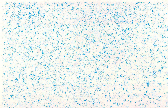
FIGURA 7. A. Patrón de aspersión (espectro) de una boquilla nueva.
