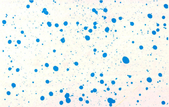
FIGURA 7. B. Patrón de aspersión de una boquilla desgastada por el uso.
