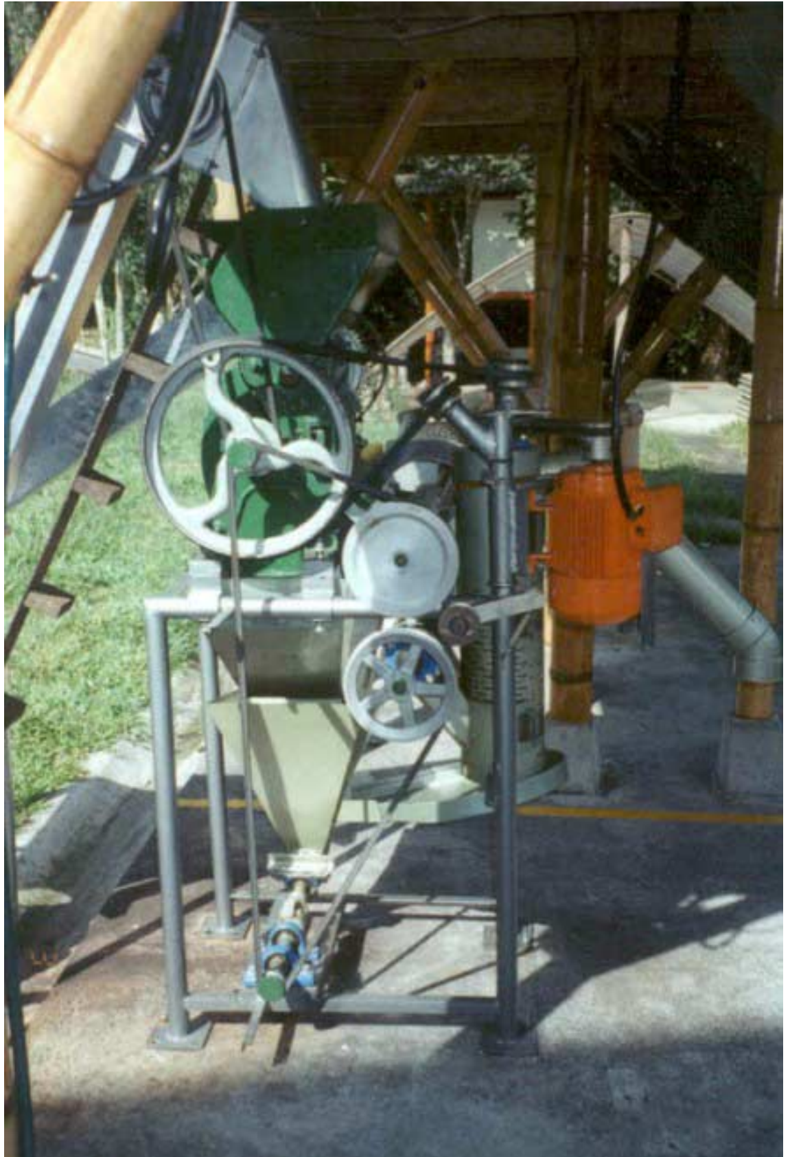
Figura 4. Detalle de la transmisión de potencia del modelo BECOLSUB 300.
