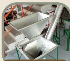
Separador hidráulico de tolva y tornillo sinfín
