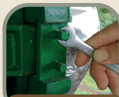
Mantenimiento de la despulpadora
