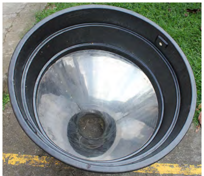
Figura 2. Cono truncado utilizado en el tanque de fermentación para permitir la descarga del café por gravedad.
