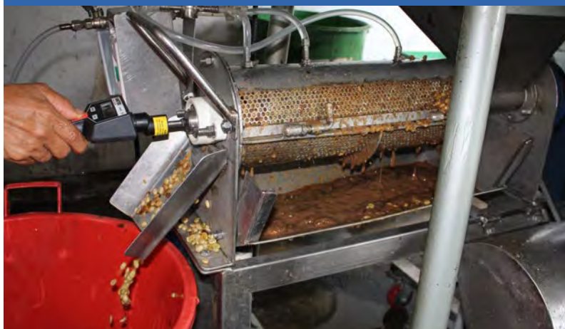
a. Lavador operando a 300 r min -1 y 0,7 L kg -1 de c.p.s.
