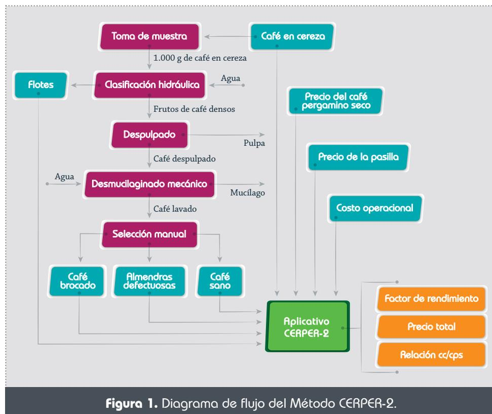
**Figura 1.** Diagrama de flujo del Método CERPER-2.
