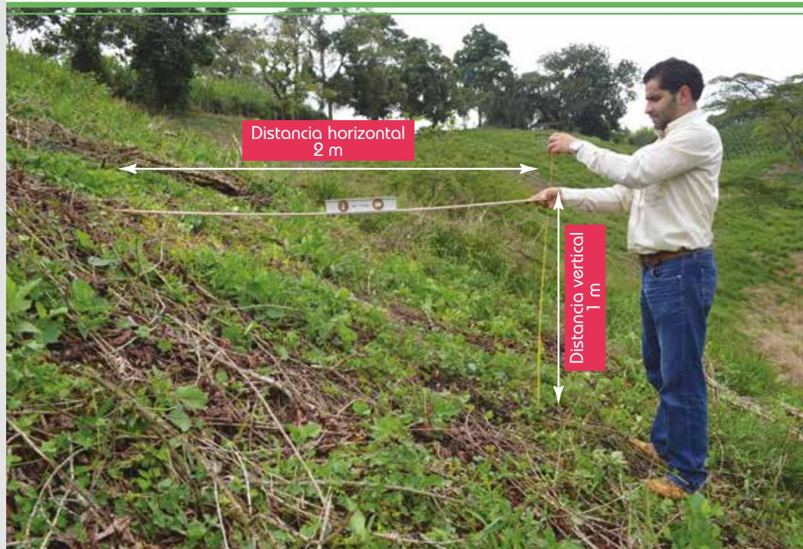
**Figura 1.** Medición de la pendiente en el terreno.
