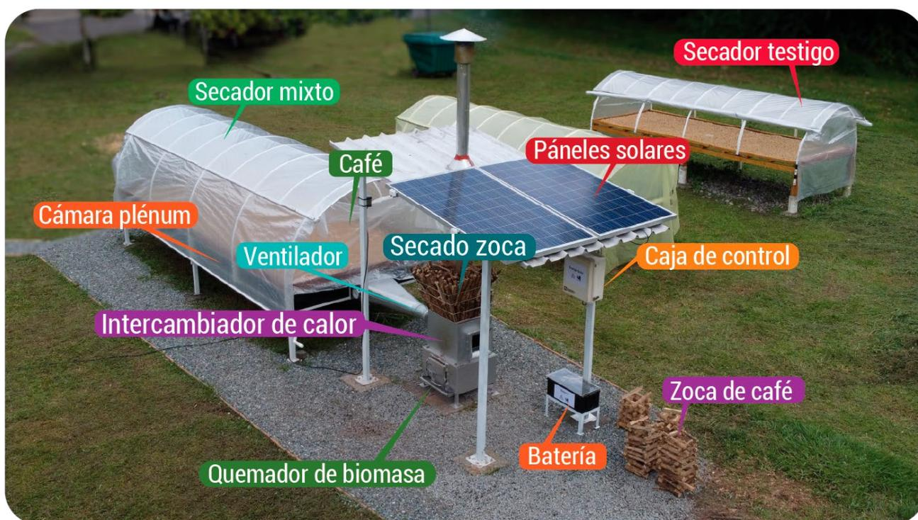
**Figura 3.** Montaje final del secador mixto.
