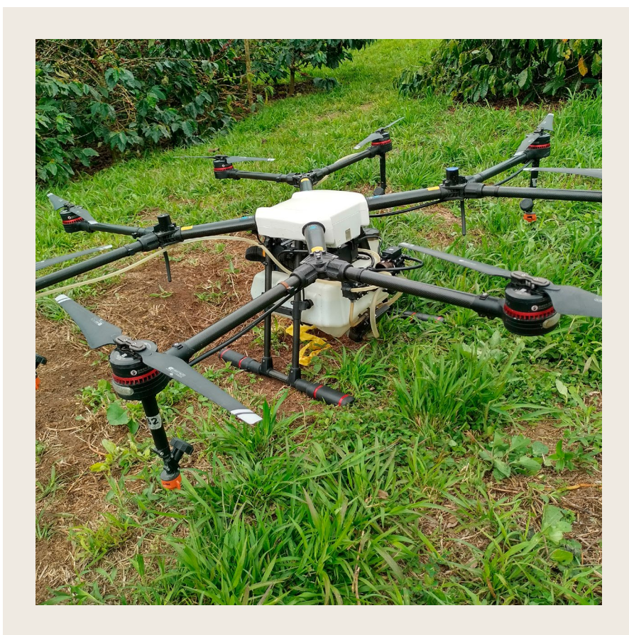
Figura 1. Dron de motor múltiple octocóptero para aspersiones agrícolas.
