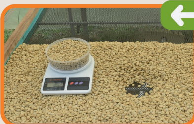
Figura 5. Secado solar con diferente altura de capa y seguimiento con el método Gravimet.
