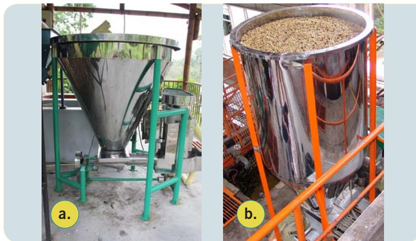
**Figura 1.** Tanque utilizado para la fermentación del mucílago del café en la tecnología: **a.** ECOMILL<sup>®</sup> 500; **b.** ECOMILL<sup>®</sup> 1.500 y 3.000.
