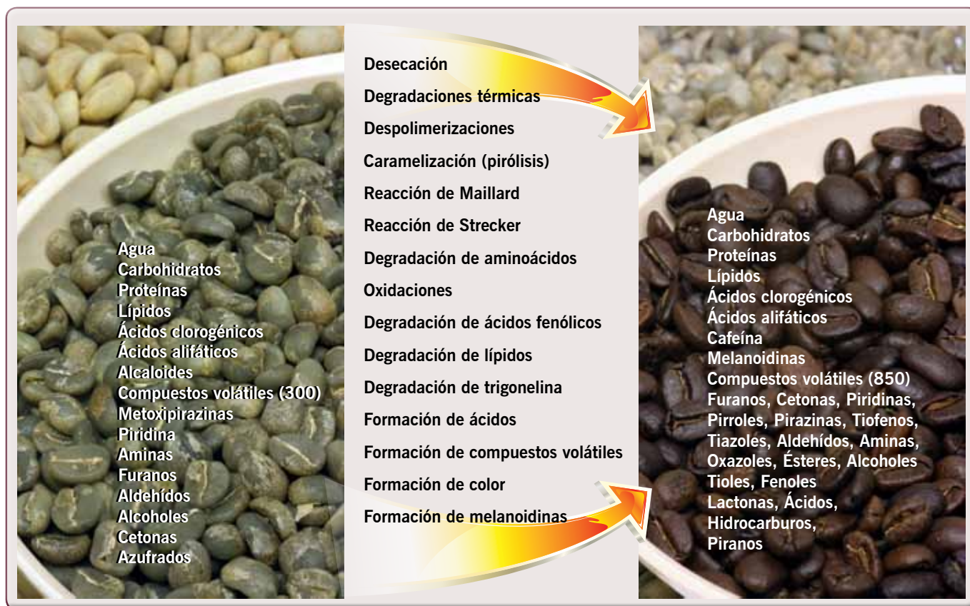
Figura 3. Esquema de las principales reacciones químicas en la tostación de los granos de café y los compuestos formados.
