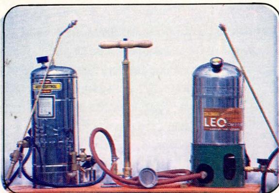
SE ESTAN PROBANDO CON EXITO ALGUNOS ADITAMENTOS O ACCESORIOS LLAMADOS "PORTABOQUILLAS" PARA ASPERSION SIMULTANEA CON VARIAS BOQUILLAS, LO QUE INCREMENTA LA EFICIENCIA DEL EQUIPO AL REDUCIR NOTABLEMENTE EL NUMERO DE JORNALES POR HECTAREA.
