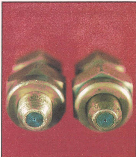
Punta de boquilla nueva (izquierda) y de boquilla desgastada.
