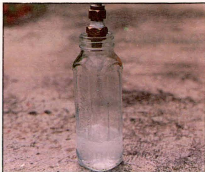
El flujo se debe medir en un recipiente aforado en centímetros cúbicos.
