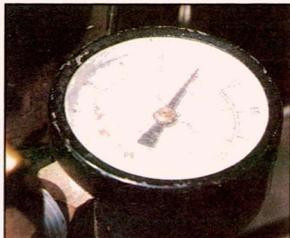
Manómetro que marca la presión de salida.
