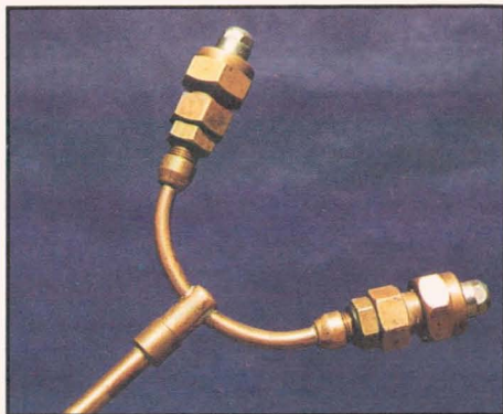
Lanza con boquillas de la misma referencia.
