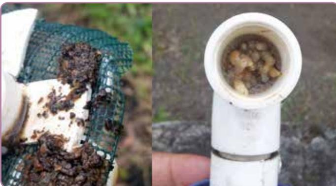
**Figura 39.** Materiales retenidos en el filtro de la trampa de sólidos.
