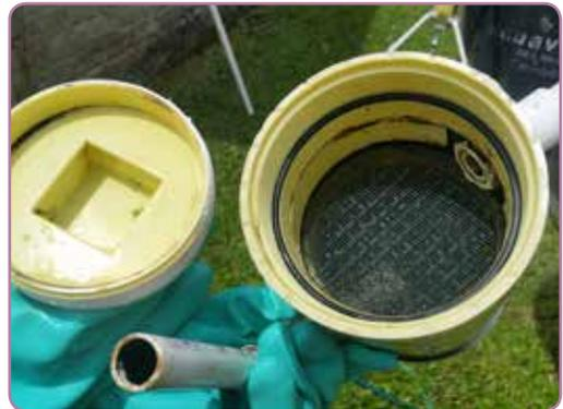
**Figura 43.** Aspecto del filtro después del lavado.
