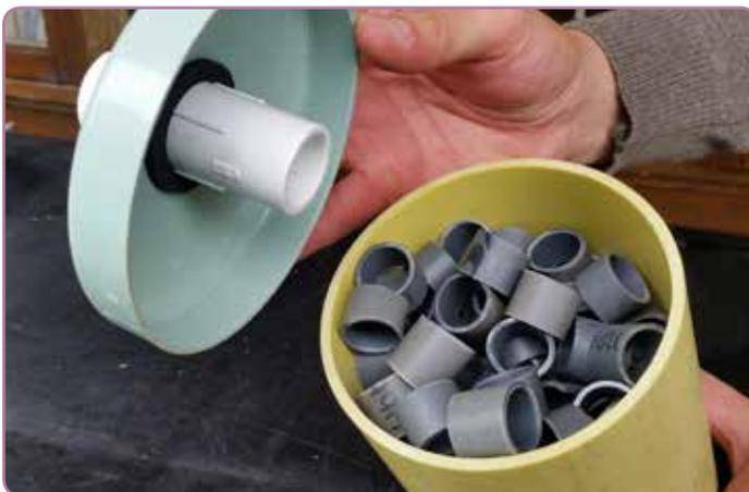
**Figura 32.** Acople del tapón de prueba al tubo PVC-S de 15 cm.
