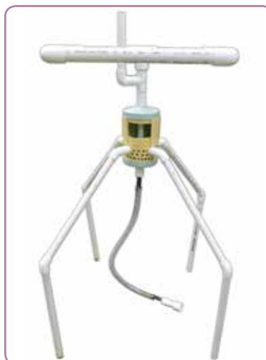
**Figura 72.** Dispositivo flotante con sistema de filtración incorporado.
