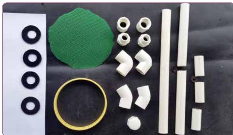
**Figura 24.** Accesorios complementarios para la construcción de la trampa de sólidos.
