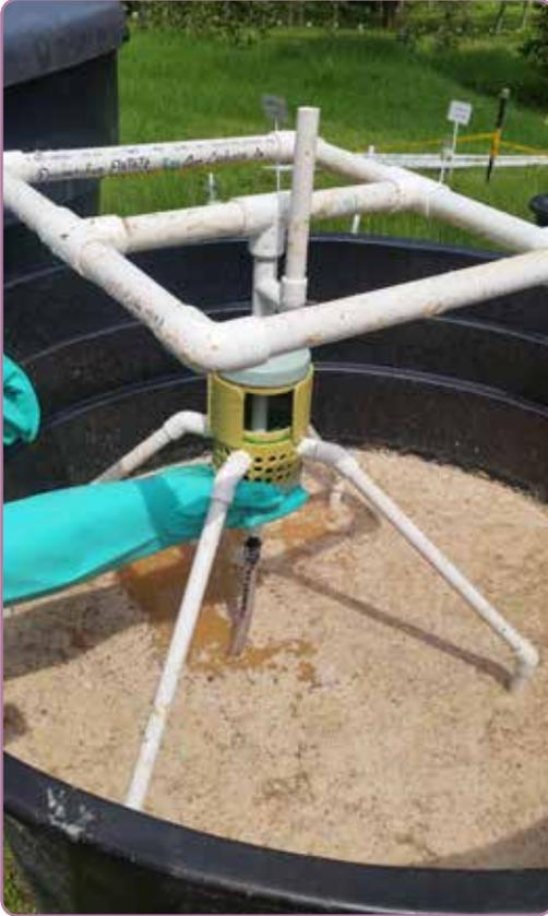
**Figura 88.** Apertura de la mirilla para el lavado interior del filtro.
