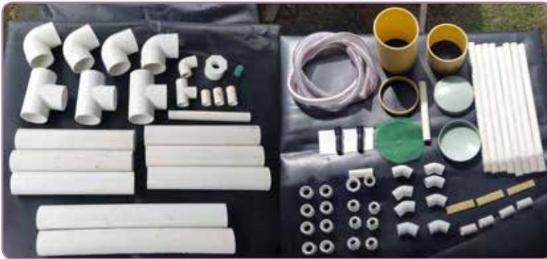
**Figura 49.** Materiales necesarios para la construcción del dispositivo flotante.
