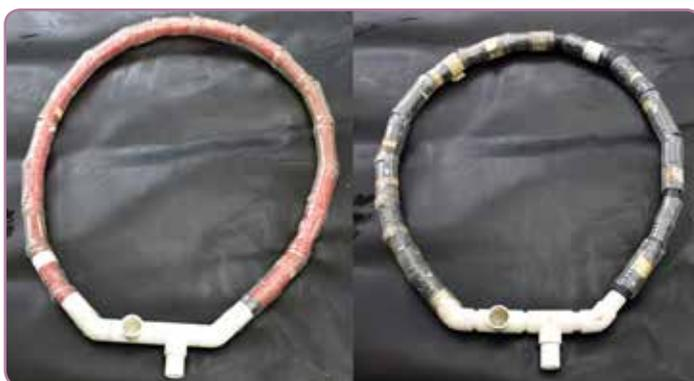
Figura 20. Aspecto final del alimentador circular.
