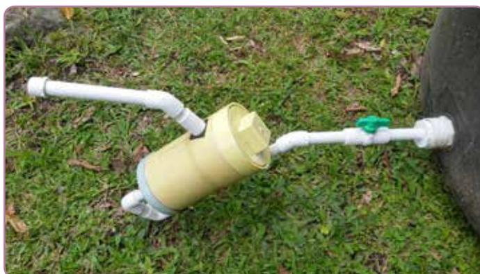
**Figura 82.** Acople de la trampa de sólidos a la salida del tanque.
