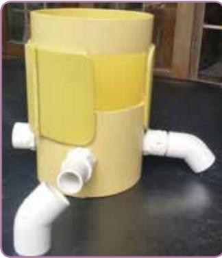
**Figura 56.** Acople de los semicodos (la ilustración corresponde al dispositivo para un tanque de 500 L).
