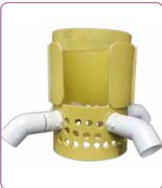
**Figura 57.** Sistema de filtración con los agujeros de ingreso del agua residual (la ilustración corresponde al dispositivo para un tanque de 500 L).
