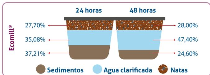
**Figura 5.** Distribución de capas en las aguas de lavado provenientes de la tecnología Ecomill®.
