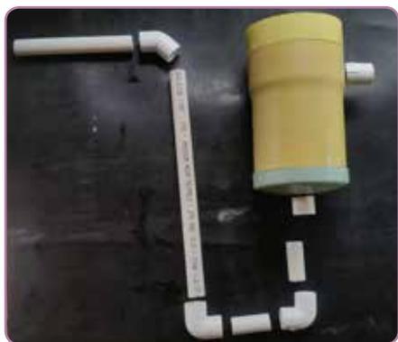
**Figura 33.** Tubería de ingreso del agua residual a la trampa de sólidos.
