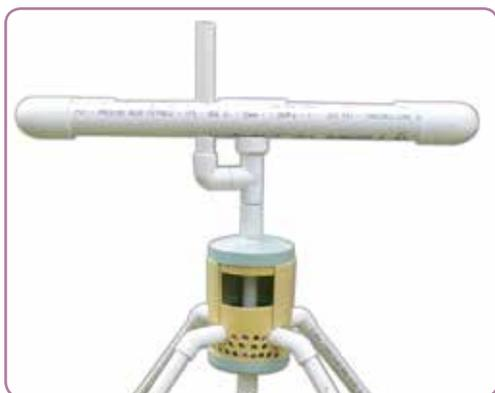
**Figura 71.** Conexión del marco flotante al sistema de filtración (la ilustración corresponde al dispositivo para un tanque de 500 L).
