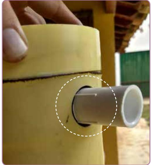
**Figura 27.** Adaptador hembra acoplado al tubo de PVC.
