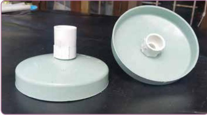
**Figura 60.** Tapones de prueba con los accesorios.
