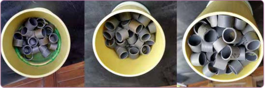
**Figura 30.** Trampa de sólidos llena con el material de empaque.
