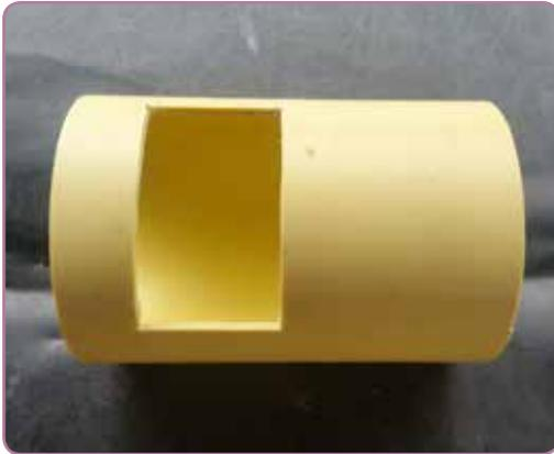
**Figura 52.** Mirilla para el mantenimiento del sistema de filtración (la ilustración corresponde al dispositivo para un tanque de 500 L).
