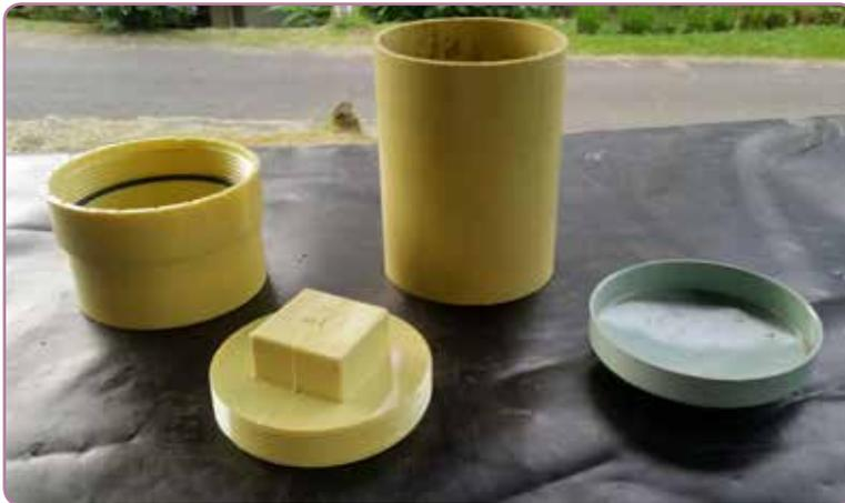
**Figura 23.** Materiales PVC-S para la construcción de la trampa de sólidos.
