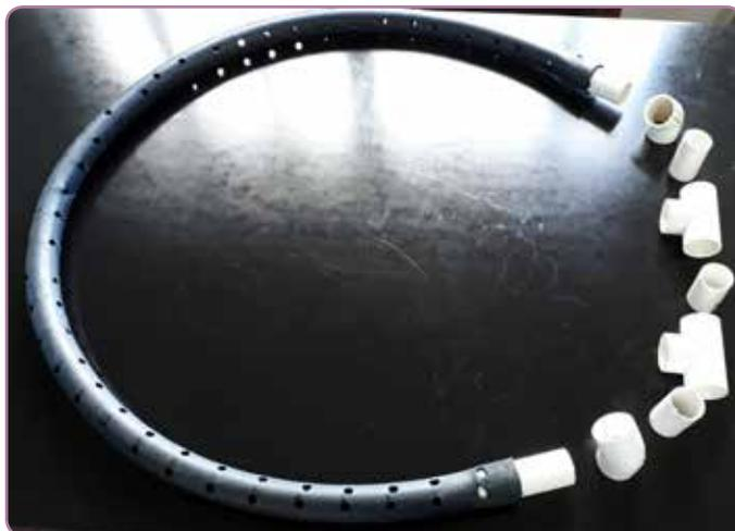
Figura 14. Componentes del alimentador circular con manguera de polietileno.
