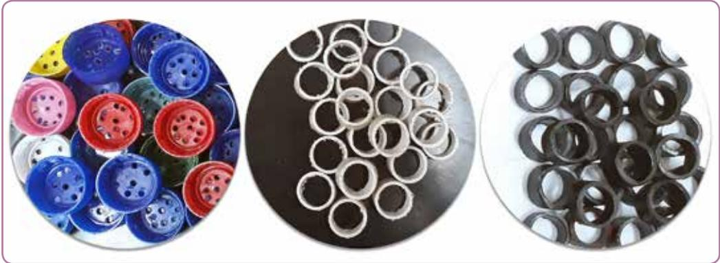
**Figura 25.** Material de empaque de la trampa de sólidos.
