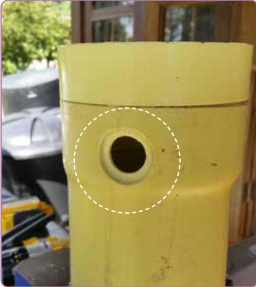
**Figura 26.** Adaptador de limpieza y agujeros incorporados al tubo de PVC.
