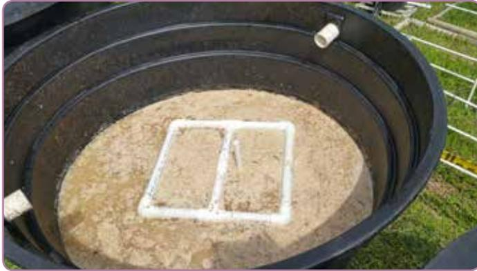
**Figura 84.** Dispositivo flotante de cabeza de presión constante en operación.
