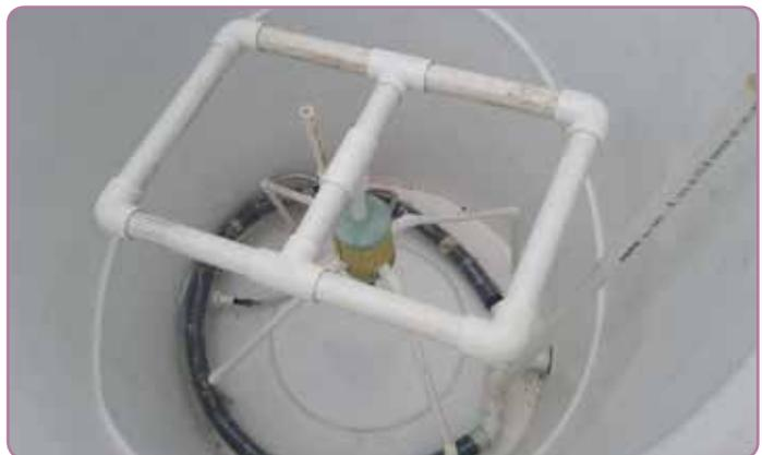
**Figura 79.** Acople del dispositivo flotante en el interior del tanque.
