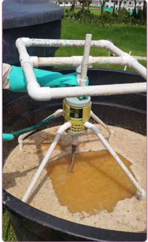
**Figura 89.** Lavado del interior del filtro del dispositivo flotante.
