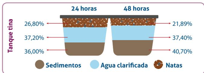
**Figura 4.** Distribución de capas en las aguas de lavado provenientes de tanques de fermentación.
