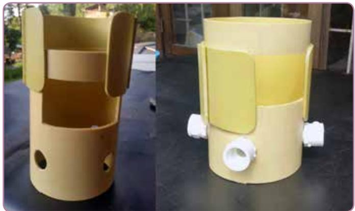
**Figura 55.** Acople de adaptadores al sistema filtrante (la ilustración corresponde al dispositivo para un tanque de 500 L).
