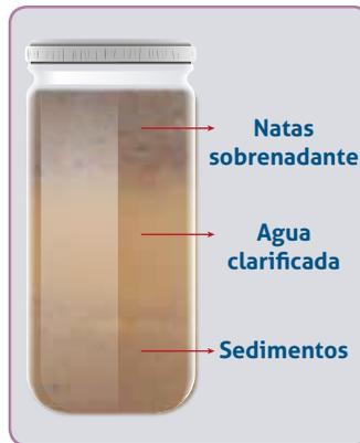
**Figura 3.** Aspecto de las capas del agua residual que se forman en el interior del reactor hidrolítico.
