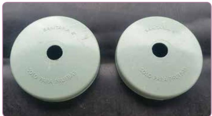
**Figura 59.** Tapones de prueba con las perforaciones.
