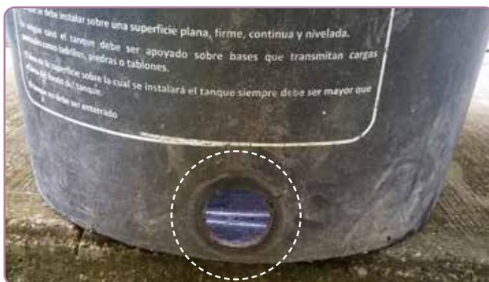
Figura 74. Agujero inferior del tanque comercial.
