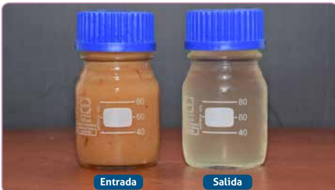
**Figura 86.** Aspecto del agua de ingreso y de salida del dispositivo flotante.
