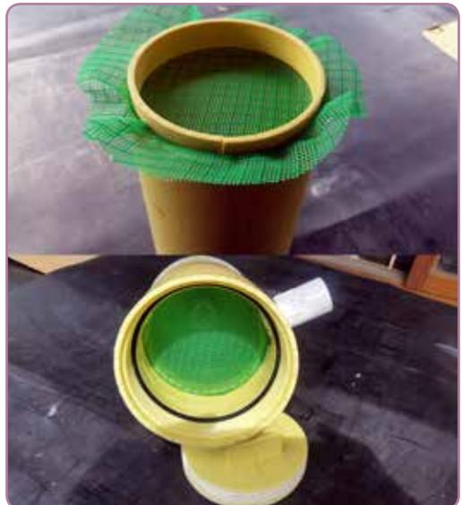
**Figura 29.** Filtro incorporado al tubo de PVC-S de 15 cm.
