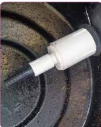
**Figura 78.** Acople del extremo de la manguera del dispositivo flotante al adaptador.
