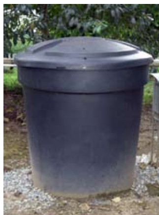
Figura 13. Tanque de polietileno utilizado como reactor metanogénico.
