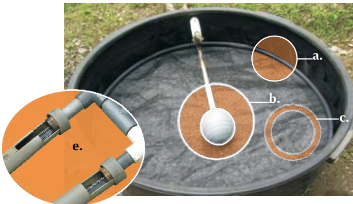
Figura 10. Componentes de la recámara de dosificación: a. aro en manguera de polietileno de 1/2", b. válvula flotador en PVC, c. malla mosquitera, d. marco colector de líquido hacia RM, e. tapones reguladores de caudal.
