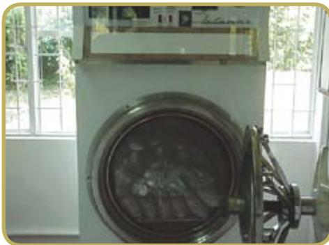
**Figura 21.** Esterilización de los sustratos en autoclave.
