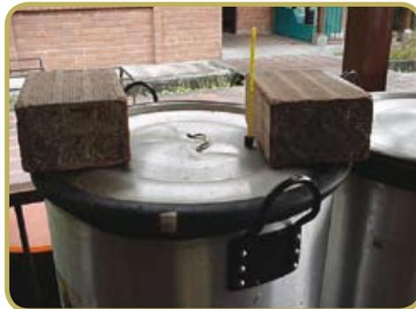
**Figura 25.** Termómetro para registrar la temperatura en sistemas a presión atmosférica.
