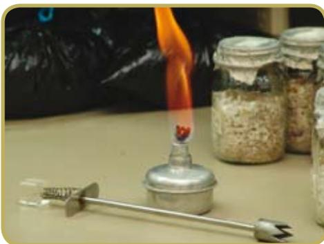
**Figura 28.** Inoculador utilizado para bloques en forma de leño.
