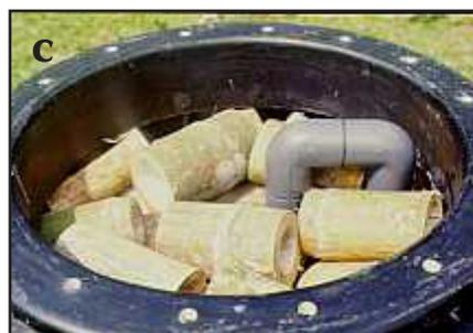
**Figura 16.** Trozos de guadua para el llenado del Reactor Metanogénico (a); perforación de los nódulos de guadua (b); llenado del reactor metanogénico (c).
