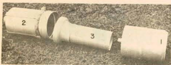
PLUVIOMETRO. (1) Boca colectora, (2) Tarro exterior, (3) Tarro interior, (4) Soporte, (5) Reglilla.
