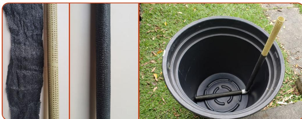
**Figura 11.** Cobertura de la tubería de salida de drenados y de aireación.
