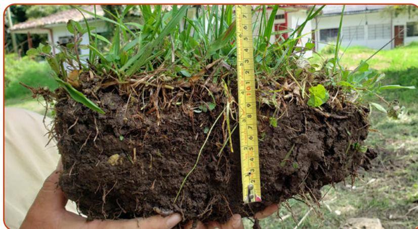
**Figura 41.** Capa de suelo y de hierba ubicada en la parte superior de la unidad de procesamiento de la biocama.
