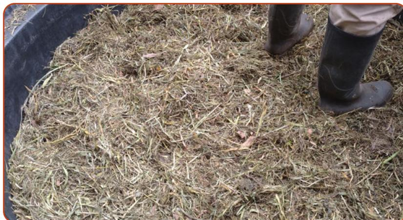
**Figura 39.** Llenado de la unidad de procesamiento hasta 10 cm antes de la altura útil del tanque.
