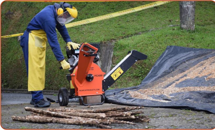
**Figura 27.** Molino para la adecuación del tamaño de partículas de los sustratos.
