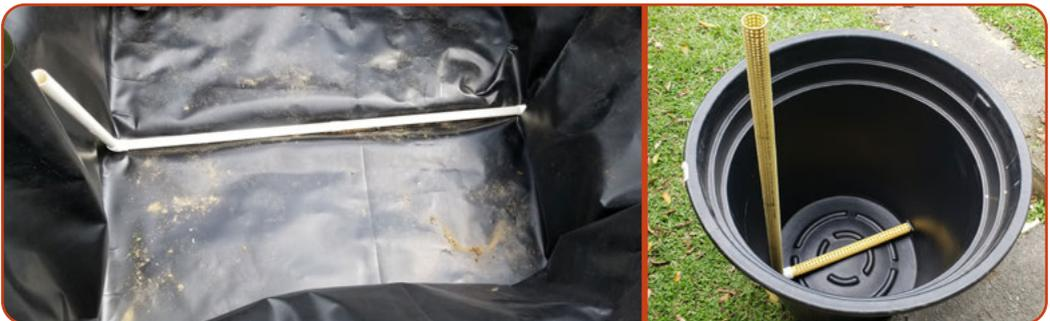
**Figura 9.** Dispositivo de aireación y drenaje del agua tratada en la unidad de procesamiento.
