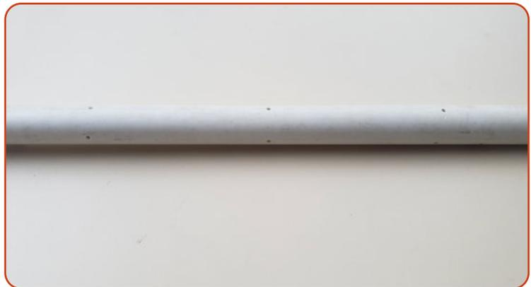
**Figura 5.** Perforaciones de 3/32" en la tubería de riego.
