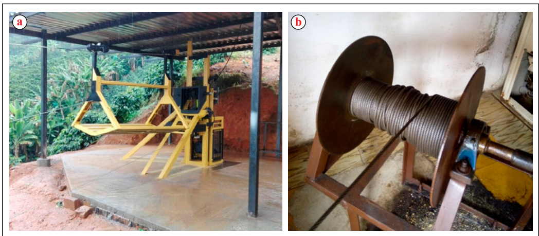
Figura 2. Sistema de arrastre del cable aéreo. a. Tipo continuo o bicable; b. Tipo cabrestante o winch .
