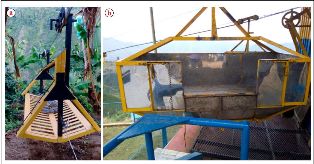
Figura 4. Tipo de plataforma de carga. a. Tipo tarima o plataforma; b. Tipo canasta.
