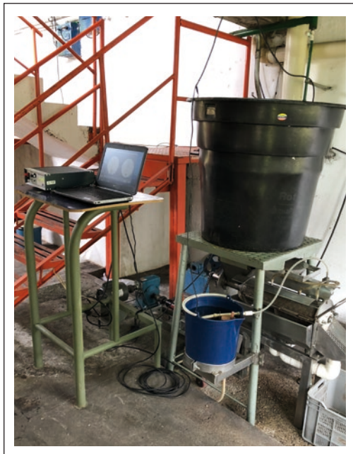
Figura 5. Dispositivo experimental utilizado para la medición de torque y potencia durante el lavado de café.
