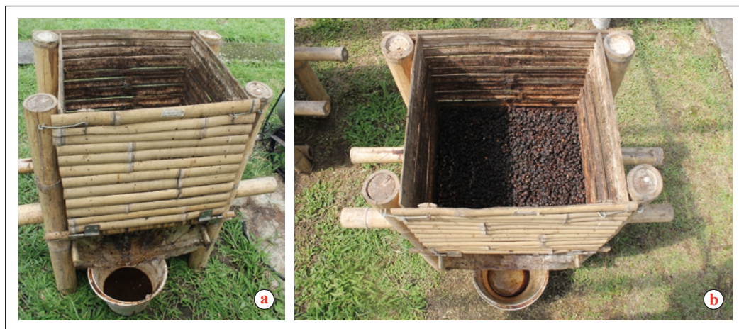
Figura 9. Aplicación a la pulpa de las aguas resultante del lavado del café con el nuevo equipo. a. Drenajes después de 24 h; b. Retención total con adición a la pulpa de los drenajes a las 36 h.
