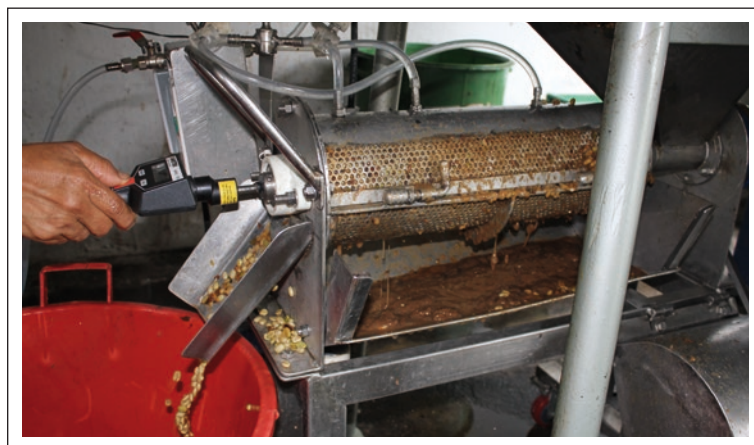
Figura 2. Medición de velocidad de giro del rotor del lavador.
