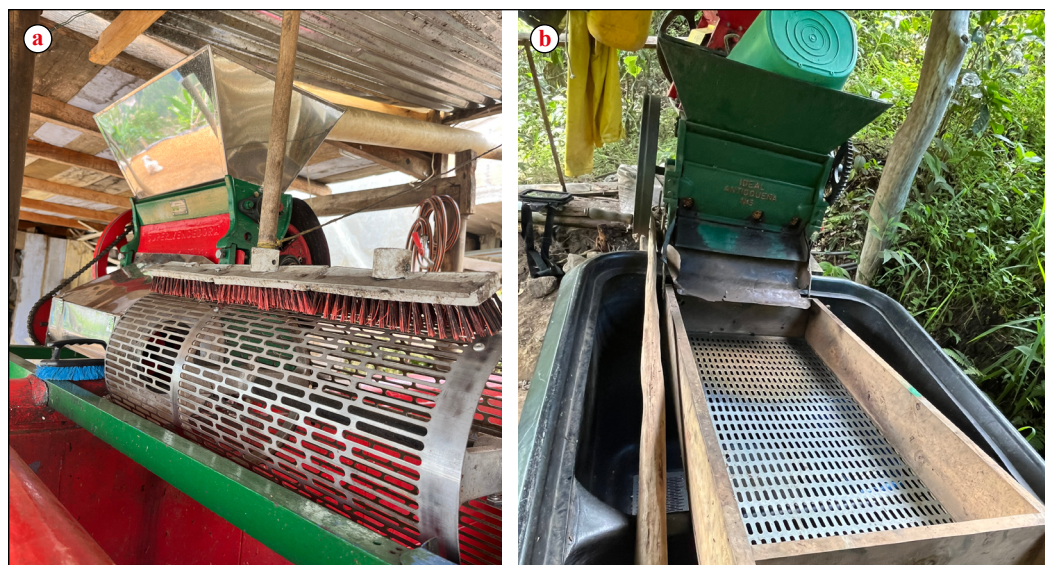
Figura 7. Sistemas de clasificación del café despulpado. a. Zaranda cilíndrica; b. Zaranda plana.
