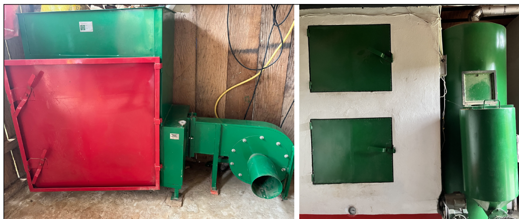
Figura 11. Silos de capa estática con capacidad de 7,0 @ de cps y 600 @ de cps.
