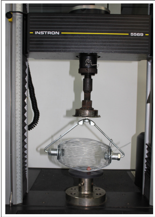
Figura 2. Empleo del equipo INSTRON 5569 en la determinación de la fuerza requerida para el ingreso de frutos de café al interior de la canastilla.
