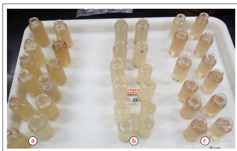
Figura 1. Muestras de agua residual después del proceso de tratamiento con las tres cales evaluadas. a. Cal apagada. b. Cal agrícola. c. Cal agrícola.
