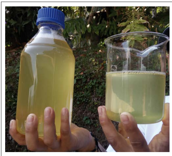
Figura 6. Aspecto del agua residual después del tratamiento primario con cal apagada.
