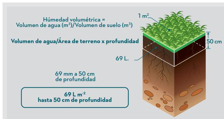
**Figura 60.** Capacidad de almacenamiento de agua en el suelo.
