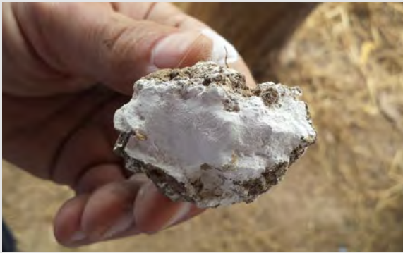
Figura 58. Capas o películas de cal por una aplicación incorrecta.
