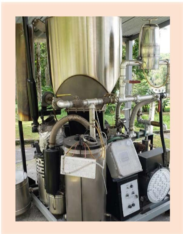
**Figura 50.** Equipo utilizado en la gasificación de los tallos de café.
