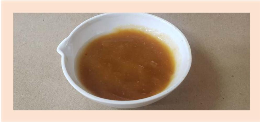
**Figura 29.** Detalle de la etapa de precipitación de pectinas de los subproductos del café.
