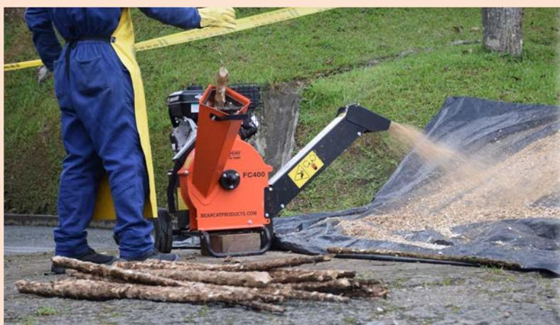
**Figura 49.** Aspecto del proceso de astillado de los tallos de café.
