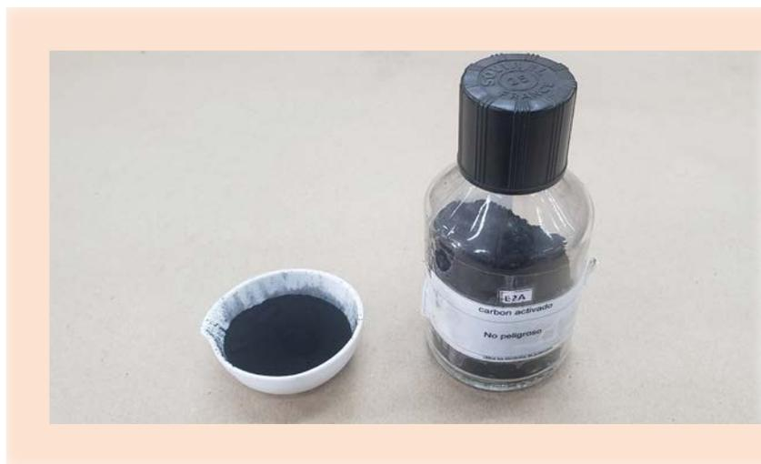
Figura 51. Carbón activado obtenido de la cascarilla de café
