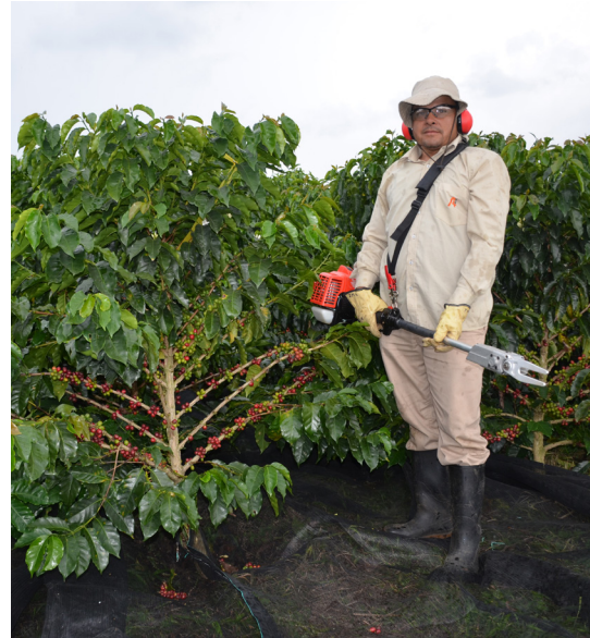
B. Derribadora selectiva
