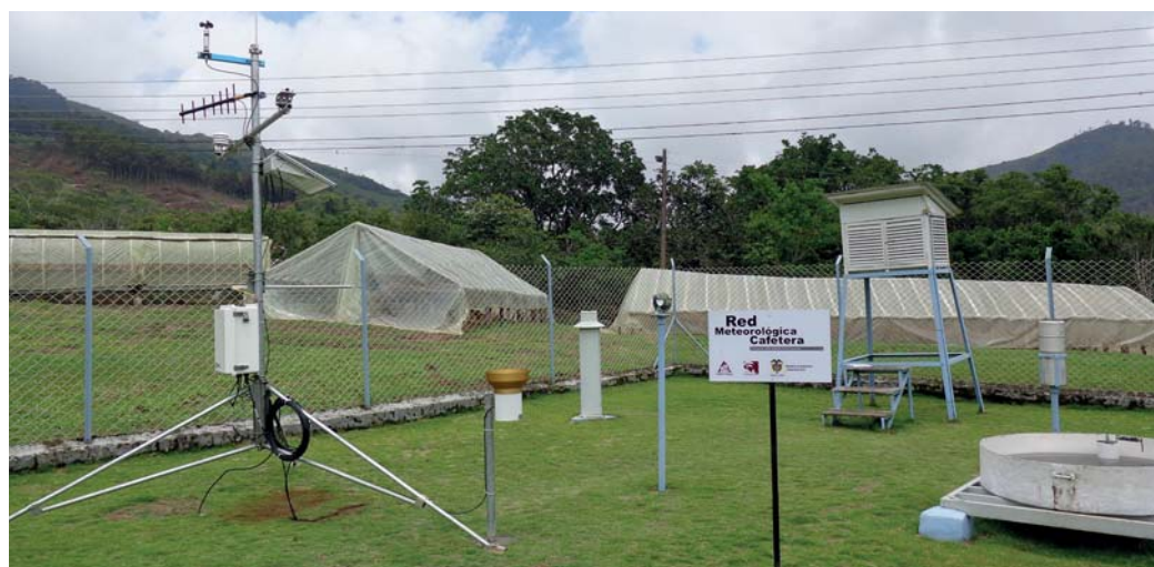
Figura 2. Estación meteorológica automática y convencional funcionando en paralelo.
