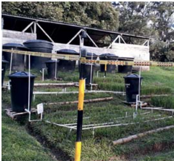
Panorámica de los tanques de alimentación al terreno. Uno por parcela.
