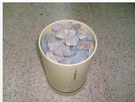
Figura 33. Granulometría de la grava utilizada en los humedales (Fuente: Rodríguez, 2009).
