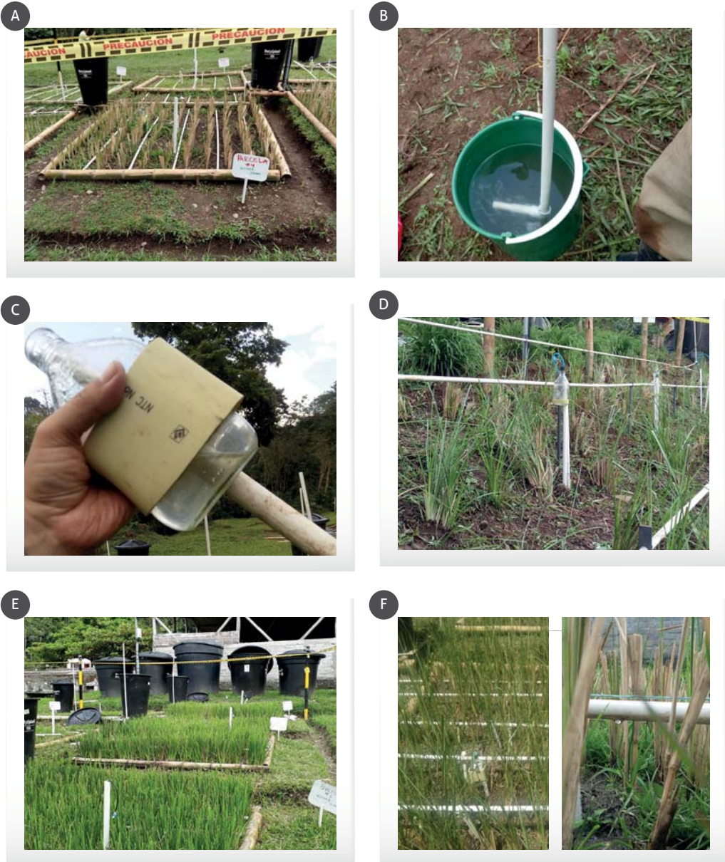
Figura 51. a) Estado de las parcelas antes del experimento. b) Cápsula de succión horizontal. c) Recipiente de recolección de muestras. d) Nivelación de la tubería de riego. e) Estado de las parcelas al finalizar el experimento. f) Sistema de distribución de flujo.
