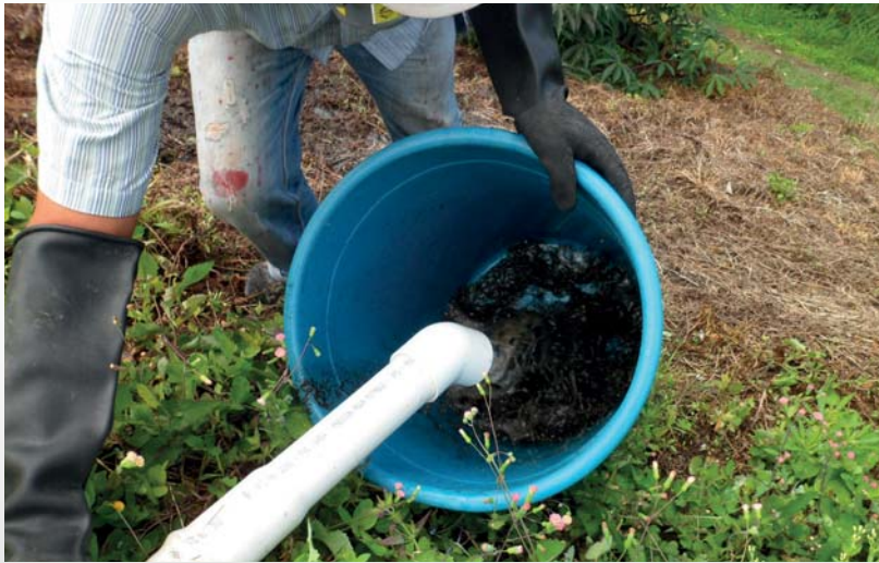
Figura 26. Salida de lodos.
